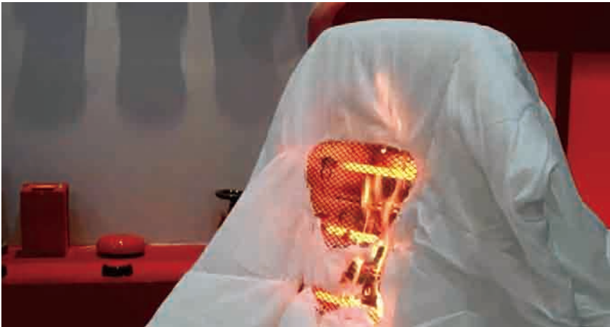
喷洒酒精后的被褥靠近取暖器后被迅速引燃
